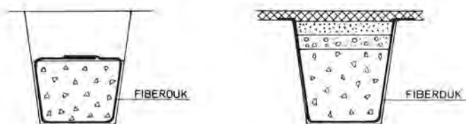
Figur 20. Den magasinbildande fyllningen i ett hålrumsmagasin sveps med syntetfiberduk
