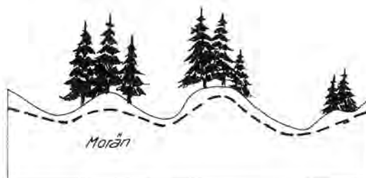
Figur 2. Exempel på grundvattenyta i morän
