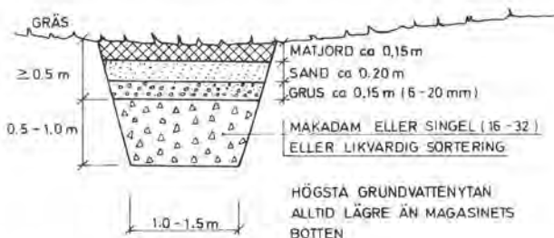
Figur 15. Principiell uppbyggnad av ett perkolationsmagasin efter Andersson, Carlstedt, Paus (1979)
