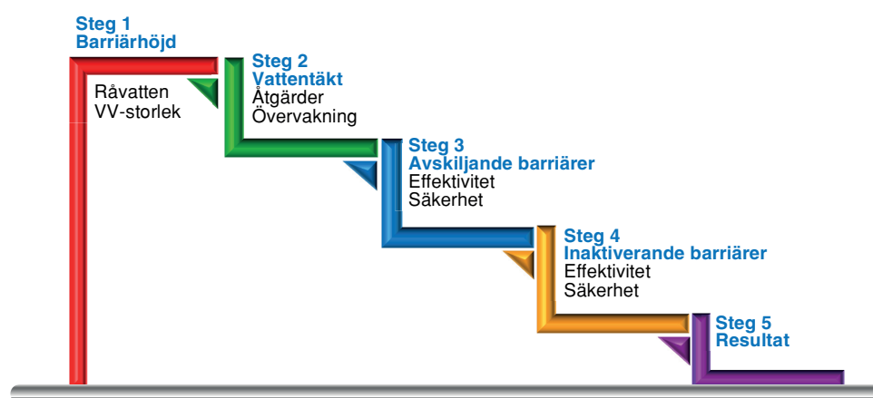
Figur 1.2 Modifierad översikt över proceduren för MBA. Summan av steg 2, 3 och 4 bör vara mer än barriärhöjden. I figuren är summan för liten – det behövs ytterligare en bit (det lila steget) för att uppnå tillräcklig barriärverkan (No figur 2.1).
