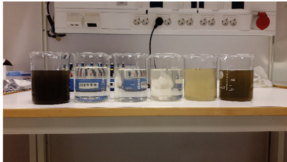
Figur 12. Kemisk fällning och sedimentering av vägdagvatten från Luleå. Notera synlig turbiditetsförändring.
