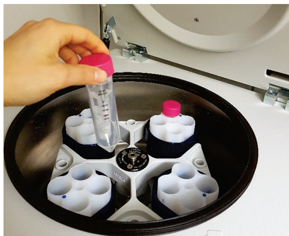
Figur 6. Ultrafiltrering för kvantifiering av lösta metalljoner i dagvatten.
