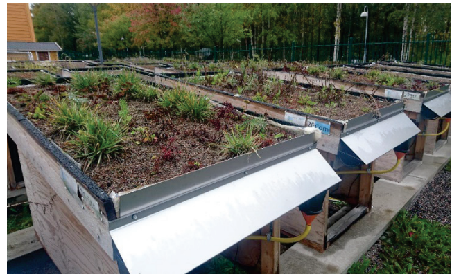
Figur 15. Flödesmätning från experimenttak på LTU.
