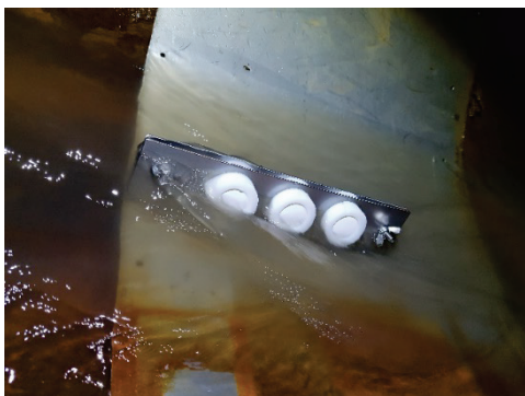
Figur 8. Passiva provtagare testas i dagvatten.
