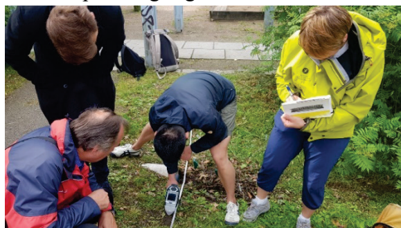
Figur 20. Mätning av metallkoncentrationer i ett svackdike – med handhållen XRF-mätare.
