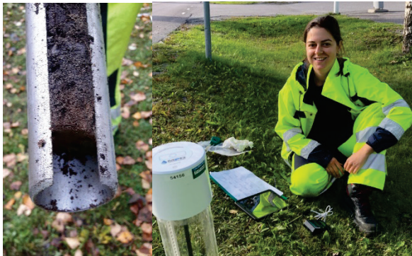
Figur 10. Provtagning av ett gräsbevuxet svackdike i Luleå.
