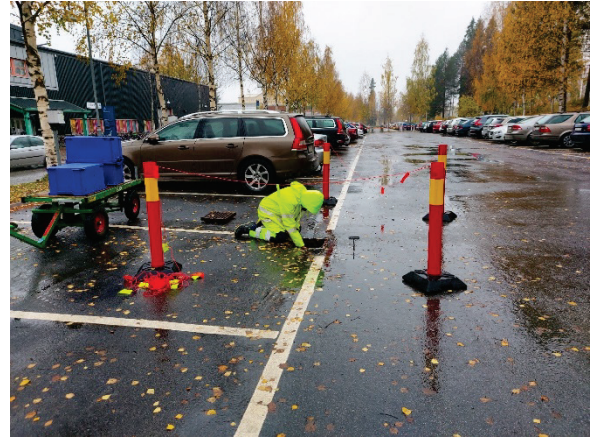
Figur 7. Provtagning av dagvatten på parkeringsplats vid Luleå tekniska universitet, Luleå.
