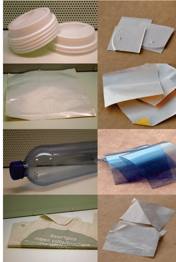
Figur 6. Plastskräp (till vänster) samt provbitar (till höger) som använts i studien. Uppifrån och ner: lock, chokladförpackning, flaska och påse. Foto: Jonathan Svedin, 2020.
