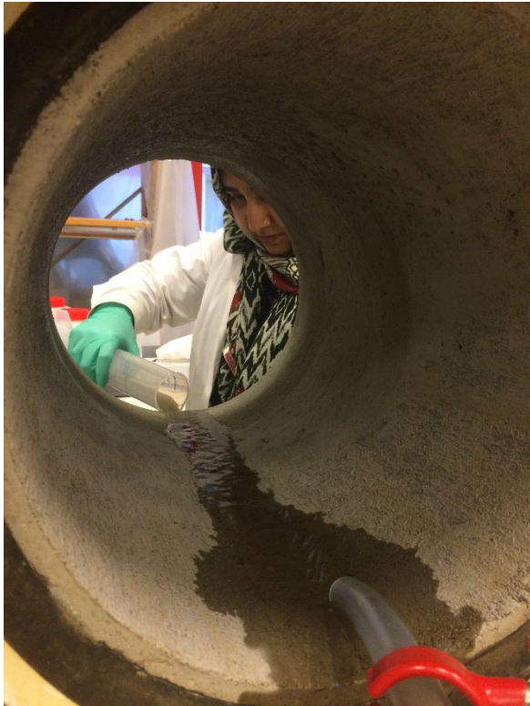
Figur 6: Påverkan av dagvattenkvalitet av olika rörmaterial undersöks i ett laborieförsök. Miljölaboratorium, Luleå tekniska universitet.
