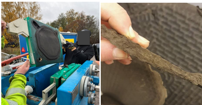
Figur 7. Filterpress i C-Green HTC-pilotanläggning (vänster) och filterpresskaka av hydrokol med en TS-halt på ca 65 % (höger). Bilderna är tagna i Margretelund november 2021).
