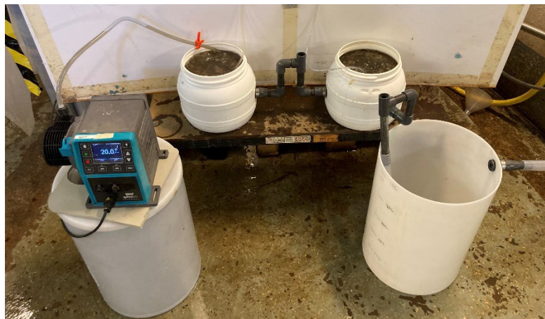
Figur 9. Sidoströmsbehandling av våtoxiderat HTC-vatten med MBBR.
