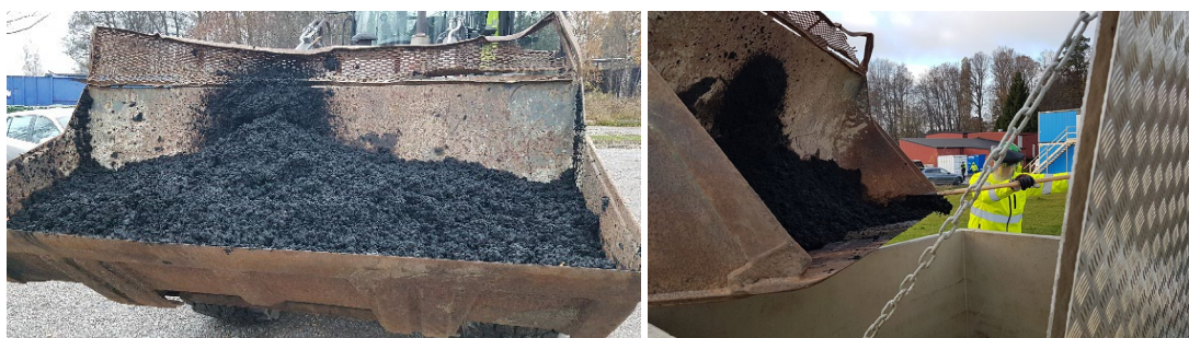
Figur 6. Till vänster visas avvattnat slam under transport till HTC-pilotens slamficka. Till höger hålls slam ned i slamfickan (bilderna är tagna i Margretelund november 2021).
