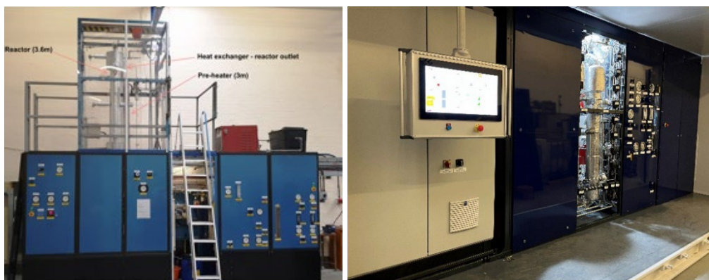
Figur 5. Pilotanläggningar för våtoxideration, med stöd för katalytisk våtoxideration. Till vänster visas den stationära anläggningen hos Frischmann Process/Aqua Dynamics i vilken HTC-vatten från Roslagsvatten våtoxiderades utan och med katalysator under kvartal 1 2022. Till höger visas C-Greens mobila containerbaserade anläggning som levererades till C-Green från Frischmann Process/Aqua Dynamics, årsskiftet 2022/23.
