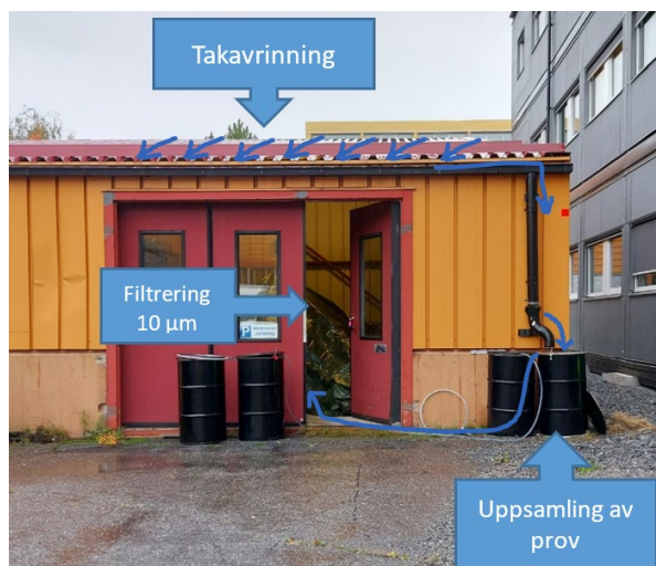
Figur 9. Provtagning av mikroplast i takavrinning.
