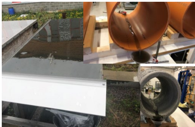
Figur 20: Insamling av avrinning från koppartak och recirkulation genom olika ledningsmaterial i laboratorieförsök.
