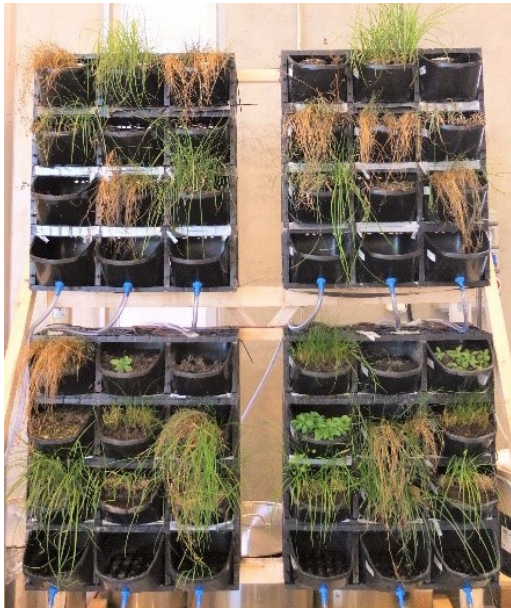
Figur 31. Gröna väggens visuella tillstånd efter 24 veckors belastning med BDT-vatten/Re-coLab.
