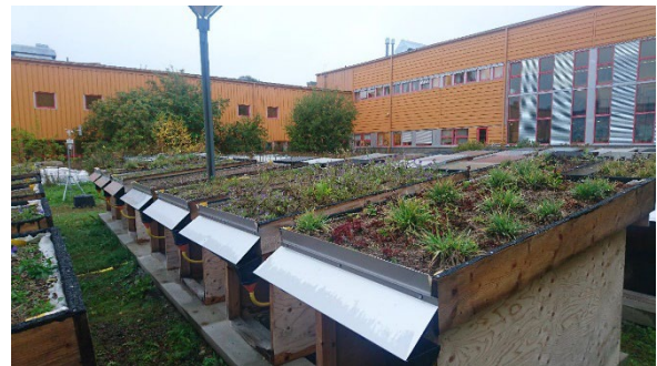
Figur 18. Pilottaken på Luleå tekniska universitet där avrinning från naturliga regn mätts under tre säsonger.
