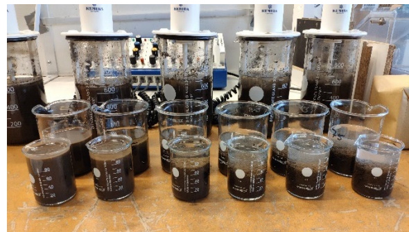
Figur 17: Avvattning av sediment från dagvattendamm och analys av rejecktattnet. Miljölaboratorium, Luleå tekniska universitet.
