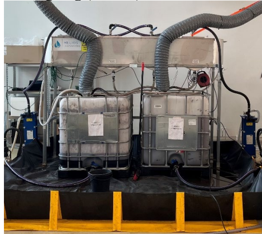
Bild 20. Försöksupställning med evaporator i pilotskala, RecoLab.
