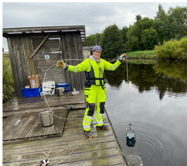
Bild 1. Användning av Ekmanprovtagare för sedimentinsamling vid provtagning i Fyrisån, Uppsala (september 2023).
