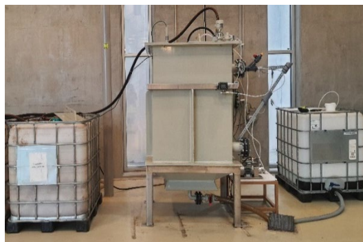
Bild 21. Försökupställning med membranfilter på RecoLab, Helsingborg.
