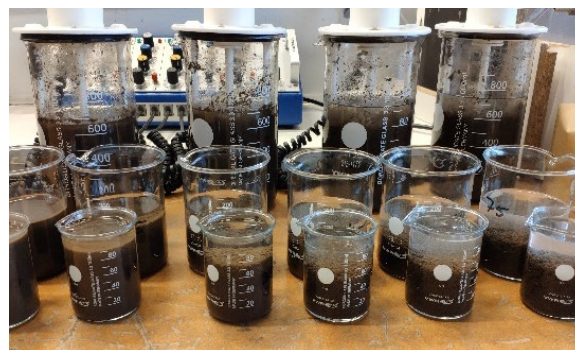
Bild 10: Avvattning av sediment från dagvattendamm och analys av rejektvattnet. Miljölaboratorium, Luleå tekniska universitet.
