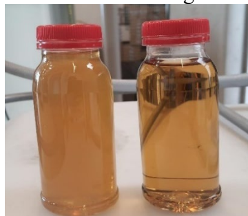
Bild 22. Kvalitet på klosettatten före och efter membranfiltrering på RecoLab, Helsingborg.
