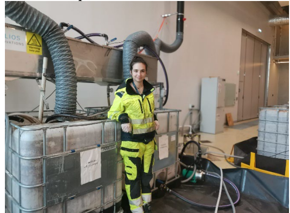
Bild 27. Försökupställning, RecoLab: avdunstare för klosettwater.
