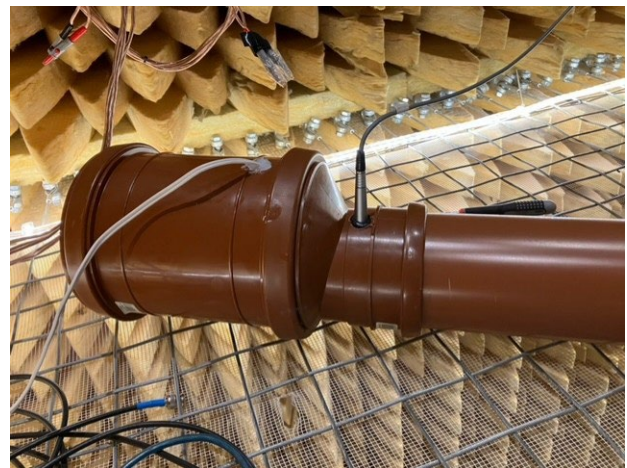
Bild 23. Installation av högtalare och mikrofon i en rörsektion i den eko-fria kammaren (november 2024).
