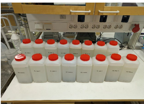
Bild 8. Duplikata prover av avrinnande dagvatten från 8 olika takmaterial - för effektbaserad analys.
