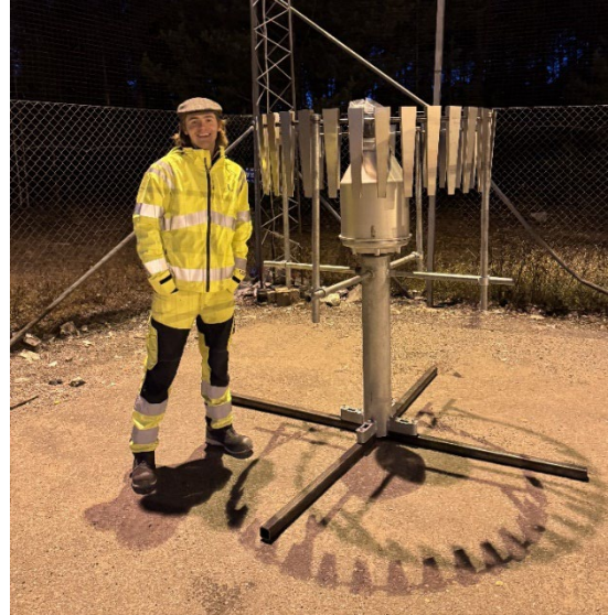
Bild 18. Installerad Geonor T-200B regnmätare
