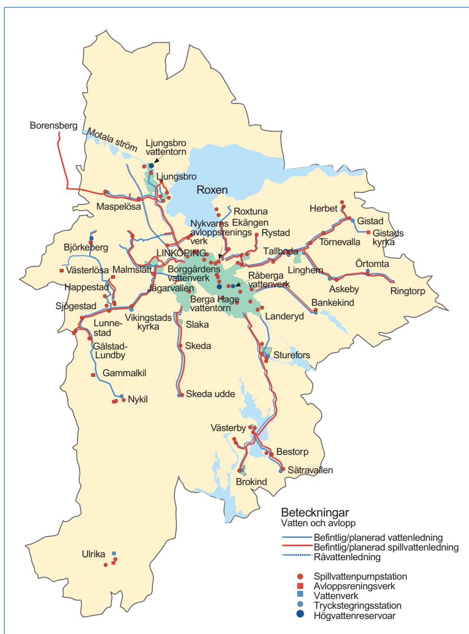
Figur 4 Avloppsledningar (överförings- ledningar) inom Linköpings kommun
