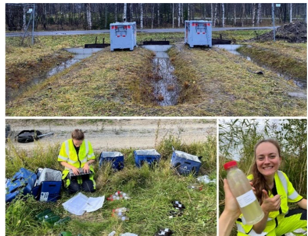
Bild 20. Infiltrationsbassänger i pilotskala (överst) och grundvattenprovtagning vid testplatsen E18 (nederst).
