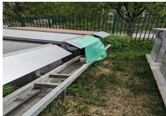
Bild 2. Duplikata prover av avrinnande dagvatten från 8 olika takmaterial - för effektbaserad analys.
