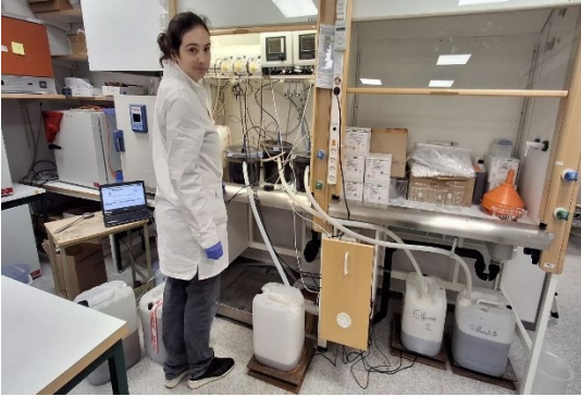
Bild 28. Nitrifikationsexperiment med klosett-vatten i pH-reglerad MBBR-reaktor.
