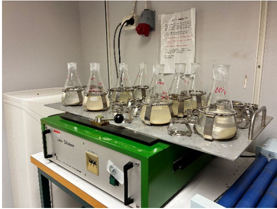
Bild 30. Uppställning för batchförsök av fosforsorption i laboratoriemiljö.
