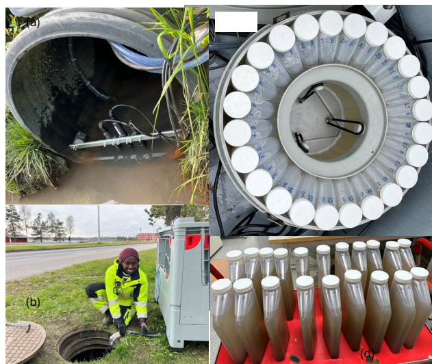
Bild 14: Installation av sensorer för pH, elektrisk konduktivitet och turbiditet i en dagvattenlednings utlopp (a), i en nedstigningsbrunn för dagvatten (b). Dagvattenprovtagning med automatisk karusellprovtagare (c) och vattenprover i laboratorium för analys av fysikalisk-kemiska parametrar och metaller (d).
