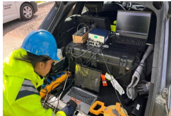
Bild 23. Insamling av fältresultat (juni 2025). Experimentuppställning i Linköping visar förstärkare, ljudgenerator, samt inspelningsenhet.
