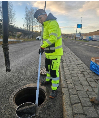
Bild 11. Provtagning av sediment i dagvattenbrunn, Trondheim (i samarbete med NTNU).
